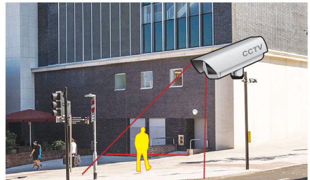
ระบบกำหนดเขตพื้นที่ห้ามเข้า (Cross-line Detection)
